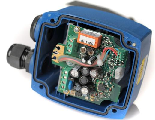
Die Drehflügelmelder sind erhältlich ohne Jumper und Mikroschalter mit integrierter Heizung. Die Heizfunktion resultiert aus einem gepulsten Gleichstrom, welcher die Temperatur am Motor auch in dessen abgeschaltetem Zustand aufrecht erhält. Somit entfällt der Einbau eines externen Heizwiderstands. Die Heizfunktion schaltet bei genügend hoher Umgebungstemperatur ab.
