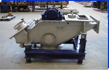
Kreisschwing-Siebmaschinen in **gasdichter** Ausführung zur **Kontrollsiebung** von Perlit.
