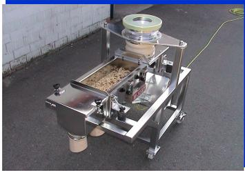
Staub- und Bruchabsiebung auf kleinen **elektromagnetisch** angetriebenen Siebmaschinen in **Kombination** mit einer Dosierfunktion.
