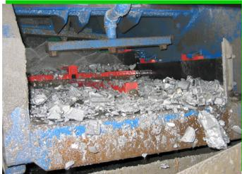
Siebmaschinen zur **Reinigung und Klassierung** von aufbereitetem Aluminium.
