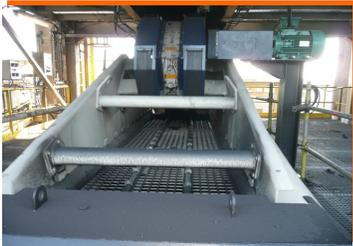
Linearschwing-siebmaschinen zur Absiebung von Rohkohle.
