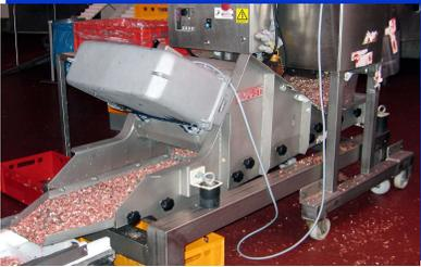
Siebmaschinen mit **elektromagnetischem Antrieb** zur Feingutabsiebung und **Dosierung** von Schinkenwürfeln.
