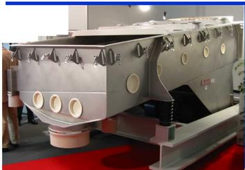
Siebmaschinen zur **Agglomeratabscheidung** von Kunststoffgranulaten bei extrem hohen Aufgabelleistungen.
