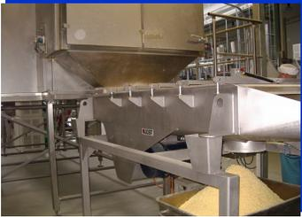
Siebmaschinen zur **Feinguttrennung** von aufgeschäumten Stärkeprodukten vor der Aromatisierung.
