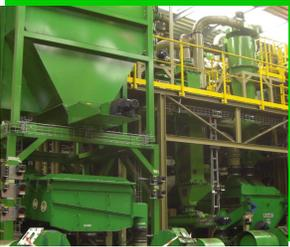
Siebmaschinen und Trenntische zur **Klassierung** und **Flusenabsiebung** von Altfreifgranulat vor der Sortierung.
