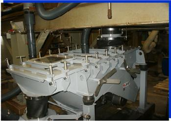
Siebmaschinen in Spezialausführung zur **Kontrollsiebung** von getrockneter Schwefelsäure.
