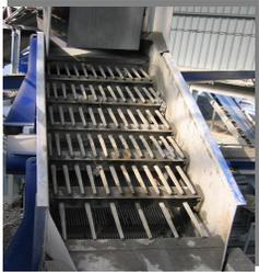
**STABROFIX** Siebmaschinen zur Vortrennung von feuchten, anhaftenden oder schwierig zu siebenden Schüttgütern bei **größeren** Trennschnitten.
