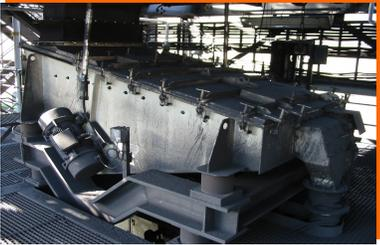
**Kontrollsiebung von pulverisierter Kohle vor der Einblasung in den Hochofen.**
