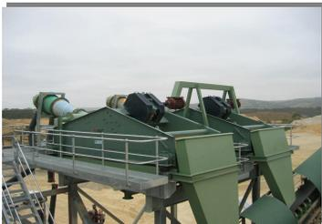
**Entwässerungs-siebmaschinen** für viele Bereiche der Aufbereitung von Mineralien und Baustoffen.
