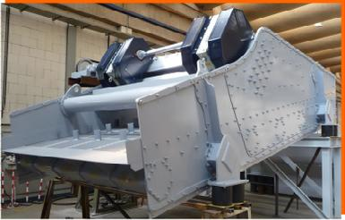
**Linearschwing-siebmaschinen zur Absiebung von Koks.**
