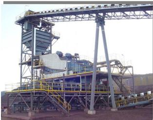
**"Banana"- Siebmaschinen**, speziell für Schüttgüter mit sehr hohem Feinanteil, ausgelegt unter Anwendung der Dünnschicht-Theorie; hier für Eisenerz.
