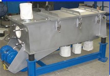
Siebmaschinen zur **Überlängenabscheidung mit Staubabsiebung** von Kunststoffgranulaten, geeignet für Strang- und Unterwassergranulierung.
