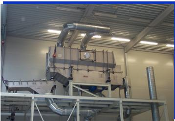
Trocknung auf Vibrationsfließbetten mit **nachgeschalteten Siebmaschinen** zur Bruch- und Klumpenabsiebung von aufgeschäumten Stärkeprodukten.
