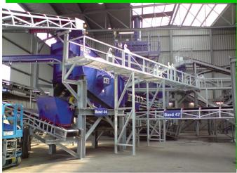
Siebmaschinen zur **Vorklassierung** von Müllverbrennungsschlacke; Metallaushaltung.
