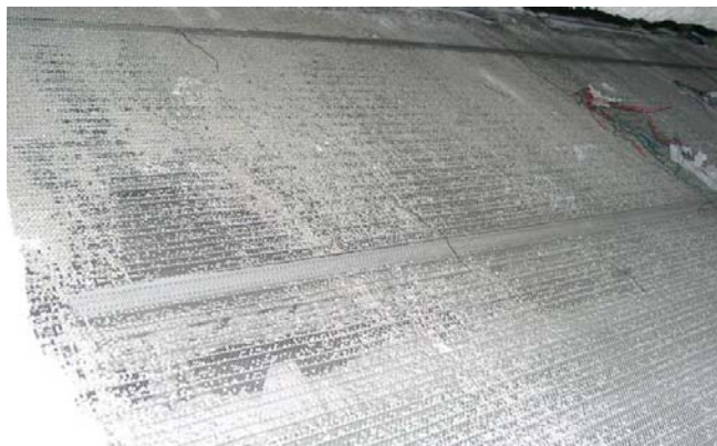
Bild 4: Siebgewebe nach drei Monaten Dauerbetrieb mit Unwuchtmotor
