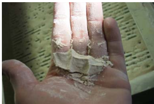
Bild 1: Feingut: feuchter, gebrochener Kalkstein mit Tonanteil, „Schneeball“
