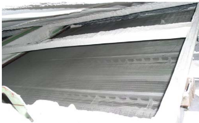
Bild 5: Siebgewebe nach drei Monaten Dauerbetrieb mit Magnetantrieb
