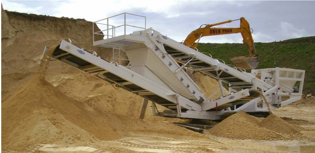
Bild 2: Direkt-Erregte-Siebmaschine als unabhängige, mobile Einheit im Steinbruch
