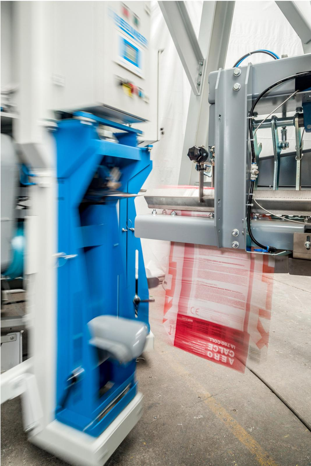
Abb. 3: Der Greifarm ist beidseitig gelagert. Damit läuft er auch unter Belastung sehr ruhig.
