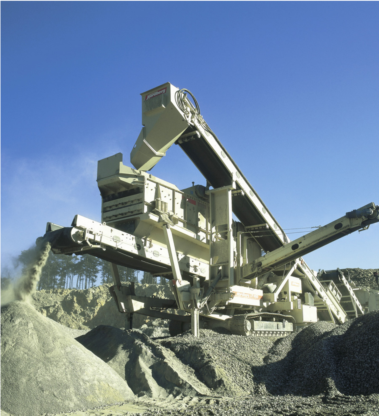
Der Lokotrack LT1100, eine Kreiselbrecheranlage mit Sieb, ist einer der meistverkauften Lokotracks in Deutschland. Im Jahr 2001 war die Anlage in einem Steinbruch in der Nähe von Osnabrück im Einsatz.
