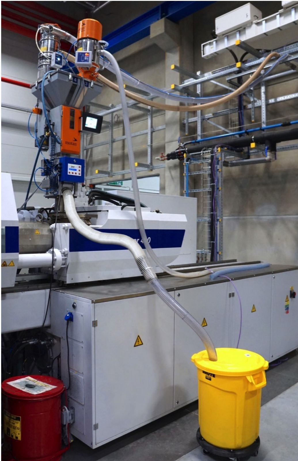
Abb. 8: Die Dosiereinheit auf der Spritzgießmaschine in Kombination mit einem Metallabscheider; blaue Zwischenstation zwischen Maschine und Dosiergerät. (Foto: Reinhard Bauer)
