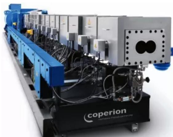
ZSK-Doppelschneckenextruder von Coperion sichern beim Chemischen Recycling von Kunststoffen eine besonders energieeffiziente, kontinuierliche Beschickung des Reaktors. (Bild: Coperion, Stuttgart Germany)
