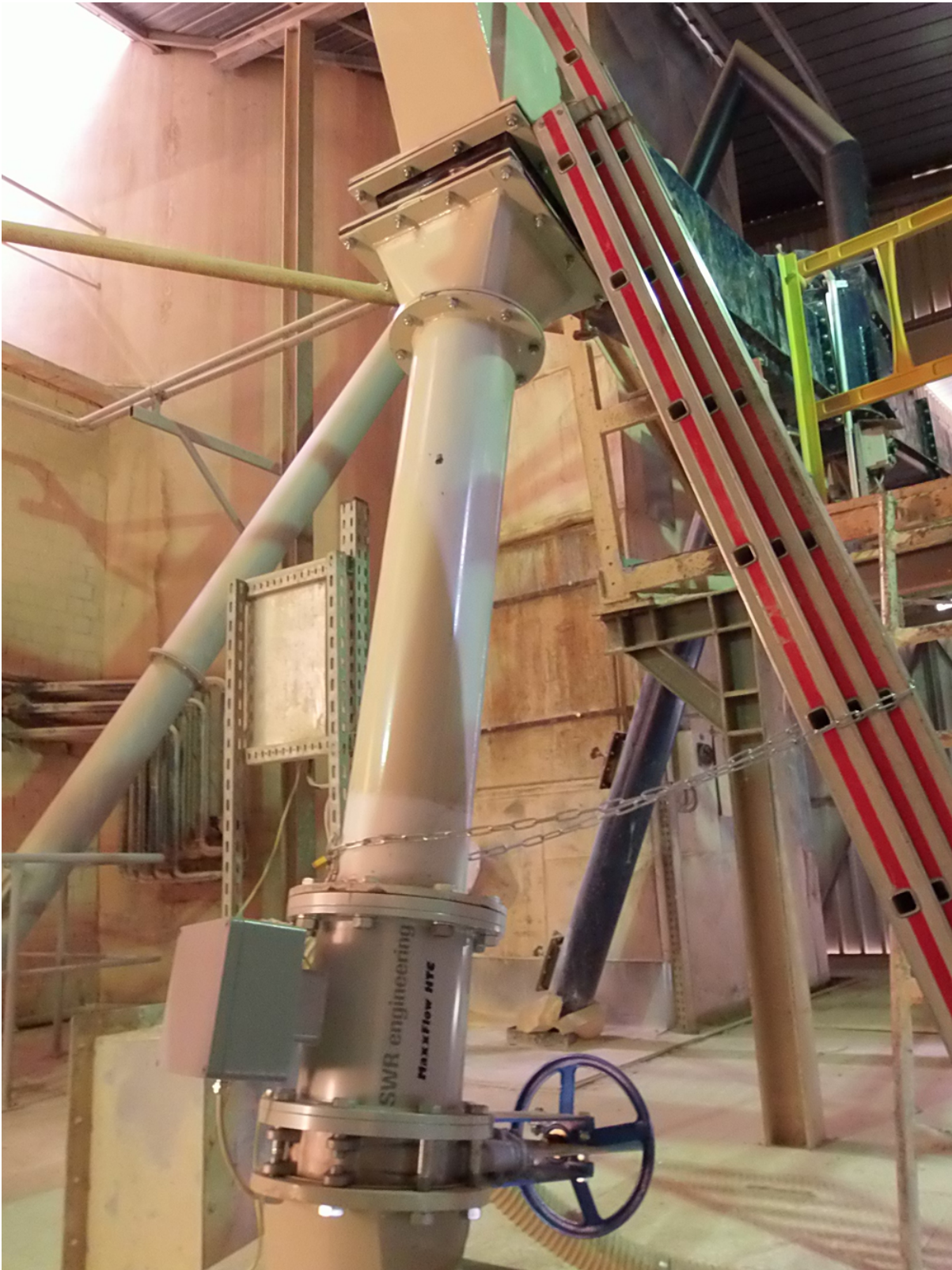
Abb. 3: MaxxFlow HTC - Mühlenrücklaufmessung in einem Zementwerk
