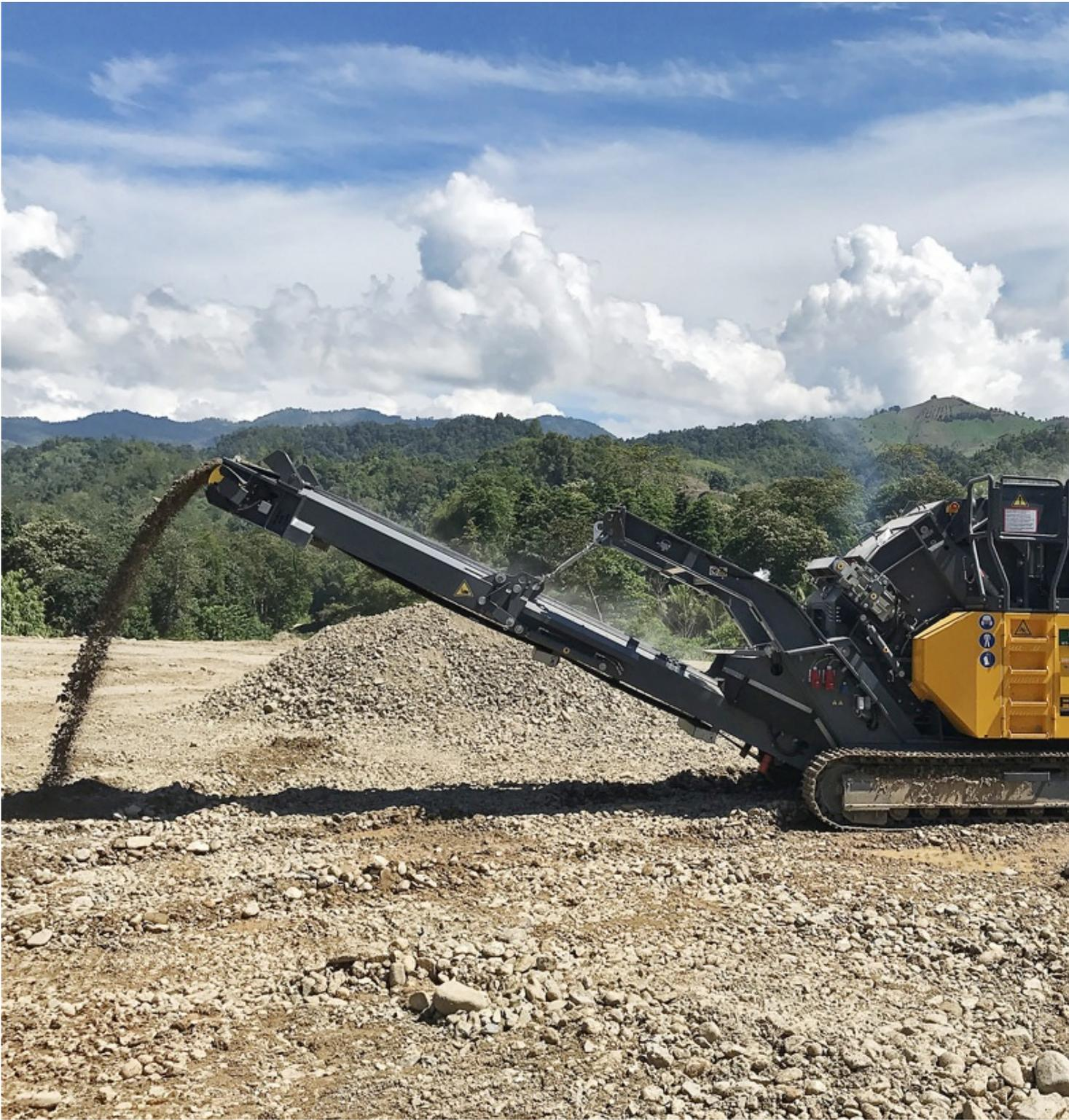
Der RM 70GO! 2.0 bereitet den extrem abrasiven Fluss-Basalt in nur einem Arbeitsgang auf.
