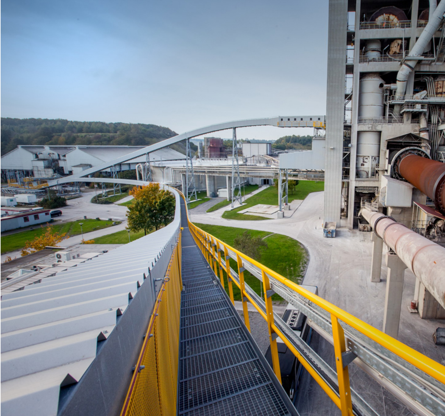
Bild 3: Die beiden Pipe Conveyor: Die BEUMER Group realisierte für die unterschiedlichen Schüttgüter auch verschiedene Systemlösungen.
