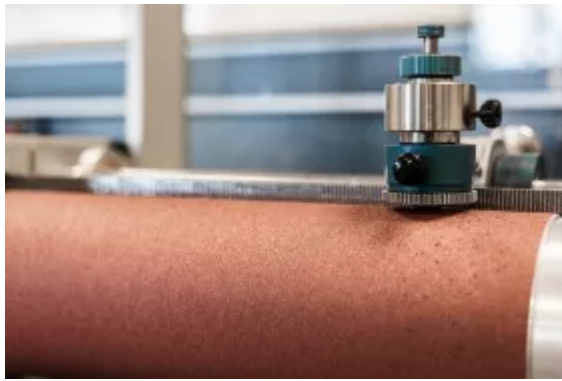
ISO 4649 / DIN 53516 abrasion testing.
