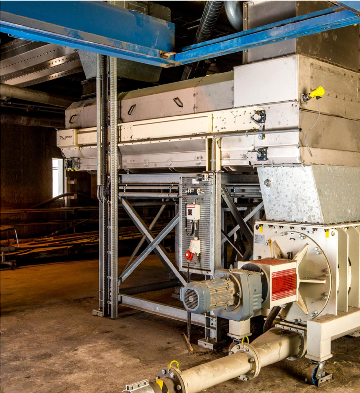
Bild 6: Die Dosierbandwaage zusammen mit dem Zellenradaufgeber inklusive Gebläse befördert das Material pneumatisch durch die Rohre zum Hauptbrenner.
