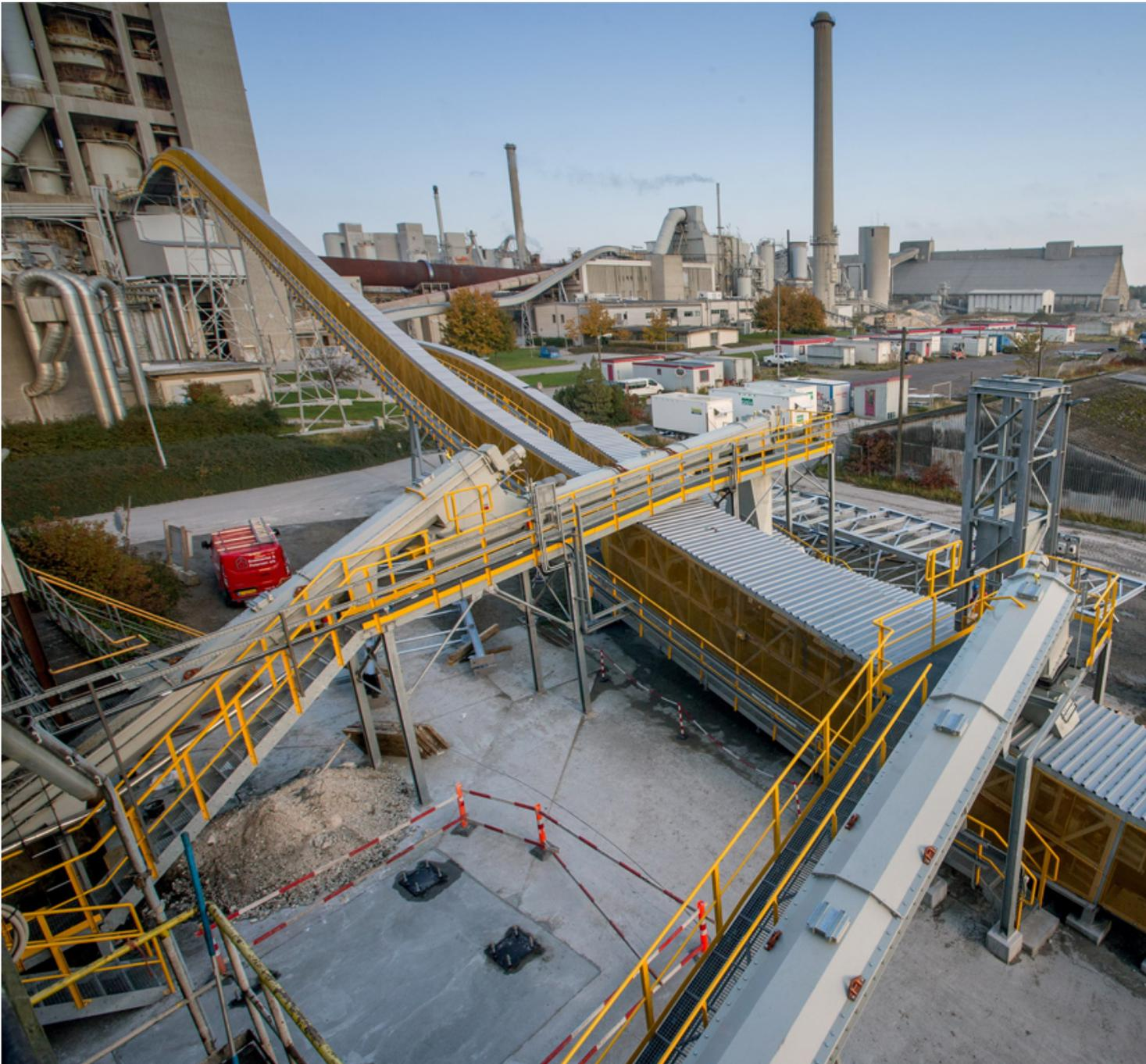
Bild 1: Die BEUMER Group lieferte an Aalborg Portland ein Komplettsystem, um Kalzinator und Hauptbrenner mit alternativen Brenn- und Rohstoffen zu versorgen. Hauptbestandteil sind die Pipe Conveyor. Beschickt werden diese über Schneckenförderer.
