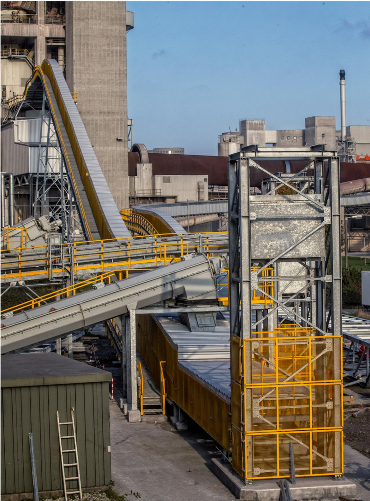
Bild 2: Die Aufgabestation des Pipe Conveyor zum Kalzinator: Dazu ist am Heck eine Spannvorrichtung angebracht.
