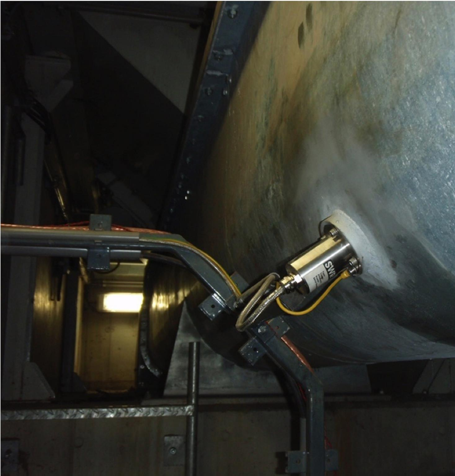
Feuchtemessung von Zement in einer Förderschnecke mit einem M-Sens Mikrowellensensor. (Bild: SWR Engineering)
