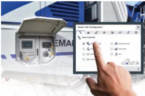
Am SPECTIVE Touchpanel lässt sich der Smart Job Configurator als „Quickstart“ für ein schnelles Einrichten der Kleemann Maschine nutzen.
