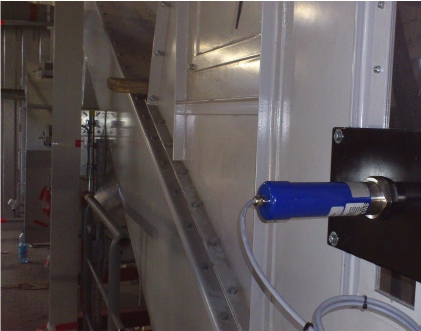
Füllstandsüberwachung mit einer ProGap Mikrowellenschranke. (Bild SWR engineering)
