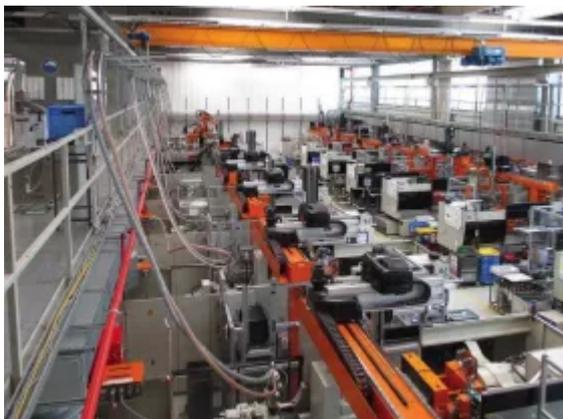
Bei P&G Braun kommen alle Kunststoffteile für die BRAUN-Produkte aus der eigenen Spritz- gießerei. An 350 Tagen im Jahr wird hier in vier Schichten an 31 Spritzgießautomaten mit Schließkräften zwischen 50t bis 300t gearbeitet.
